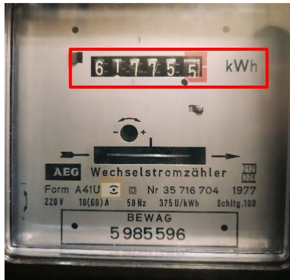
Abbildung 1: Bild eines klassischen Stromzählers
